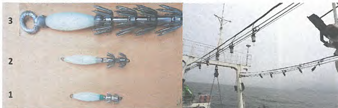
Figura 2. Poteras utilizadas durante las operaciones de Pinta (11, 15 y 37 cm). Luces calamareras de 2000 watts utilizadas en las estaciones de pinta, Cr. de Investigación del calamar gigante Cr. 1812-1901 BIC's "José Olaya Balandra" y "Humboldt".
